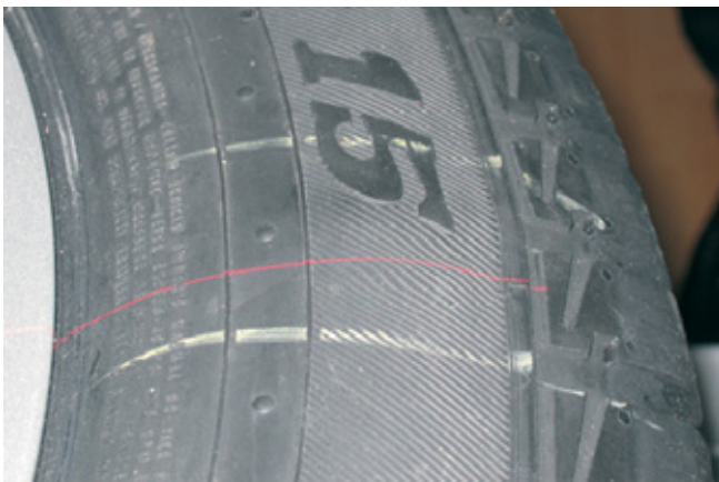
Verbeulung am Reifen - sichtbar an der Laserlinie
