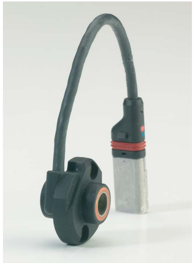
Ventilhubsensor Messbereich: 10 mm Temperaturbereich: -40...+150 °C Baulänge: 19 mm
