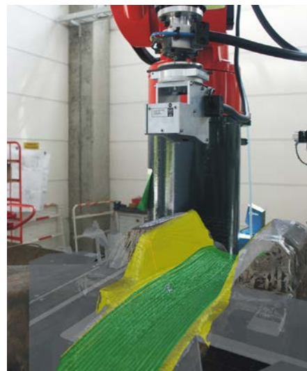
scanCONTROL Daten (gelb), berechnete Schweißbahnen (grün)
