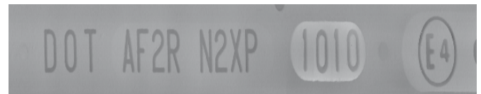
Bild der Reifenoberfläche mit scanCONTROL 2750-100
