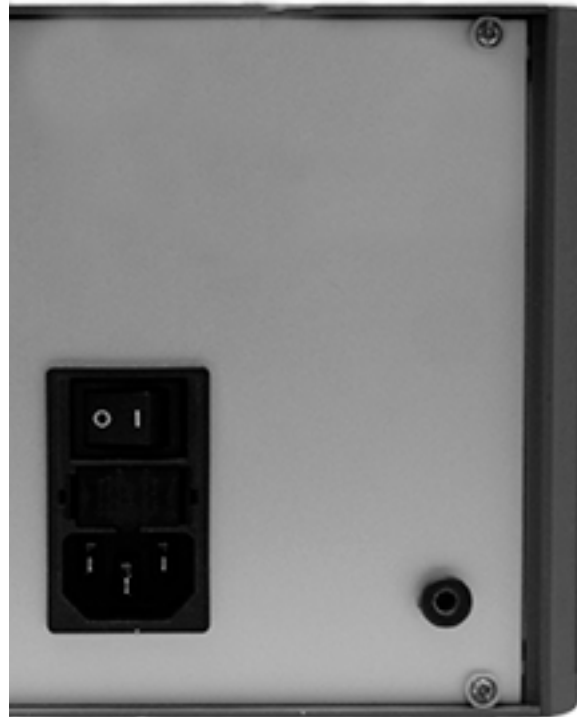
Abb. 17 Rückansicht mit Kaltgerätestecker, Sicherung; 230 VAC
