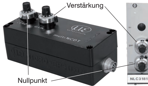
Abb. 13 Potentiometer für die Kalibrierung
