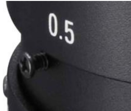
Abb. 14 Fixierung des Fokus für thermoIMAGER TIM M-1 und TIM M-05
