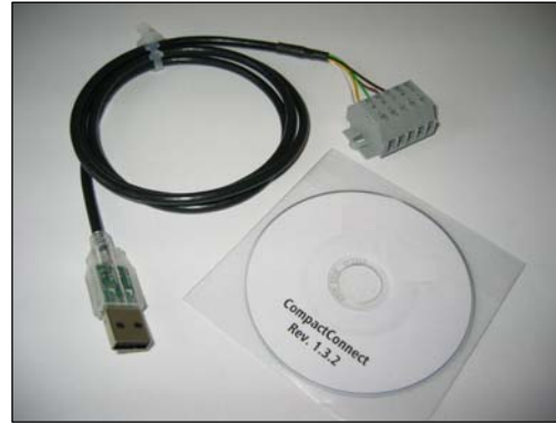
Abb. 4.12: USB-Kit: USB-Programmieradapter inklusive Klemmblock und Software-CD [TM-USBK-CS]
