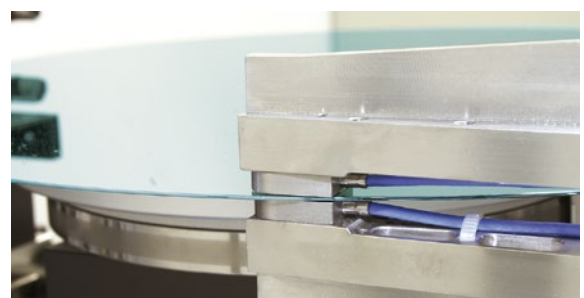
Waferdickenmessung mit zwei kapazitiven Sensoren
