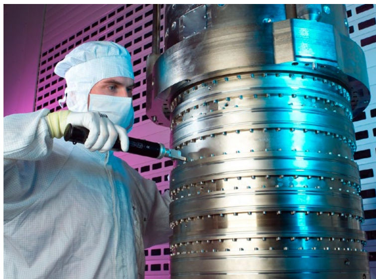
Kapazitive Wegsensoren werden zur nanometergenauen Justage von Linsen in Objektiven für die Waferbelichtung eingesetzt.
