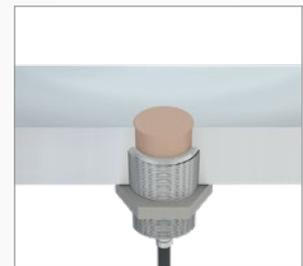
**M Bündiger Einbau bei ungeschirmten Sensoren:**
