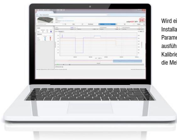
Wird ein PC über die Ethernet-Schnittstelle verbunden, kann ohne weitere Installation ein modernes Webinterface aufgerufen werden, das die Parametrierung von Sensor und Controller ermöglicht. In der Controllerausführung DT3071 stehen erweiterte Funktionen wie die 5-Punkt-Kalibrierung, die Einstellung von Schalt- und Temperaturschaltgängen und die Mehrfachkennlinienspeicherung zur Verfügung.
