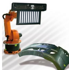
Deflektometriesysteme zur automatischen Inspektion glänzender Oberflächen Seite 12-13
