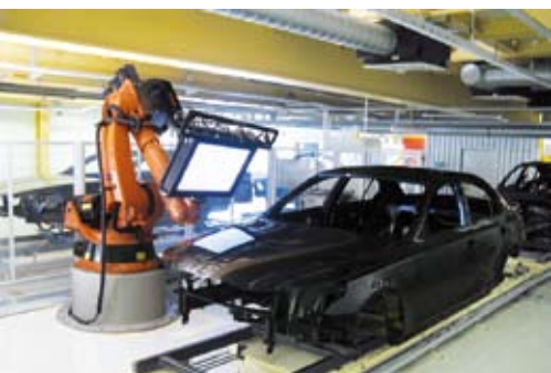
reflectCONTROL Robotic bei der Defektinspektion von lackierten Karossen
