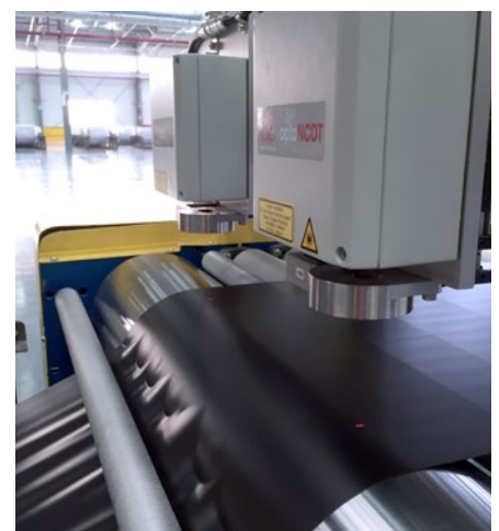
combiSENSOR des thicknessCONTROL TCP 7303.ET
