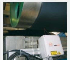
Kombisensor mit Wirbelstrom- und Lasertriangulation
