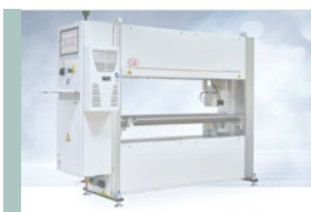
Profilometer für Reifenkomponenten thicknessCONTROL TCP 8301.CT/CLLT Innerliner, Kalandrierung Seite 14 - 15
