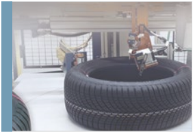
Inspektion der Reifenoberfläche Inspektion der Beschriftung TSI-LI Seite 30 - 31
