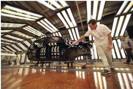
Sichtprüfungen werden durch das vollautomatische reflectCONTROL ersetzt
