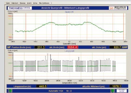
Kombiprofil TIP 8301.EO, die vertikalen Cursor zeigen die Punkte, welche zur Kalanderregelung verwendet werden
