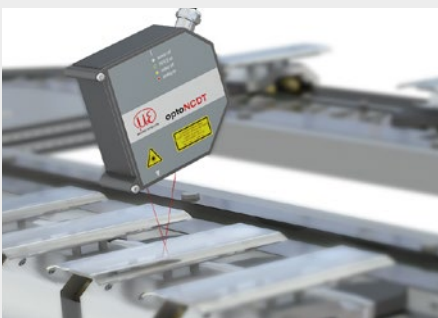
Geometrieprüfung von spiegelnden Glasteilen
