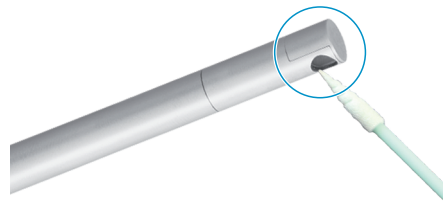
Abb. 85 Ausschnitt Schutzscheibe, radial messende Sensoren
