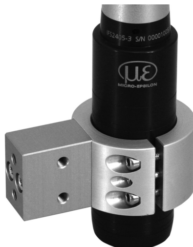
Abb. 25 Umfangsklemmung mit Montagering MA240x für Sensoren der Serie IFS2405, IFS2406 und IFS2407, bestehend aus Montageblock und Montagering
