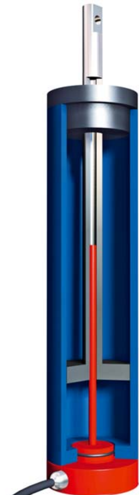
Indusensor-Serie EDS integriert in einen Hydraulikzylinder
