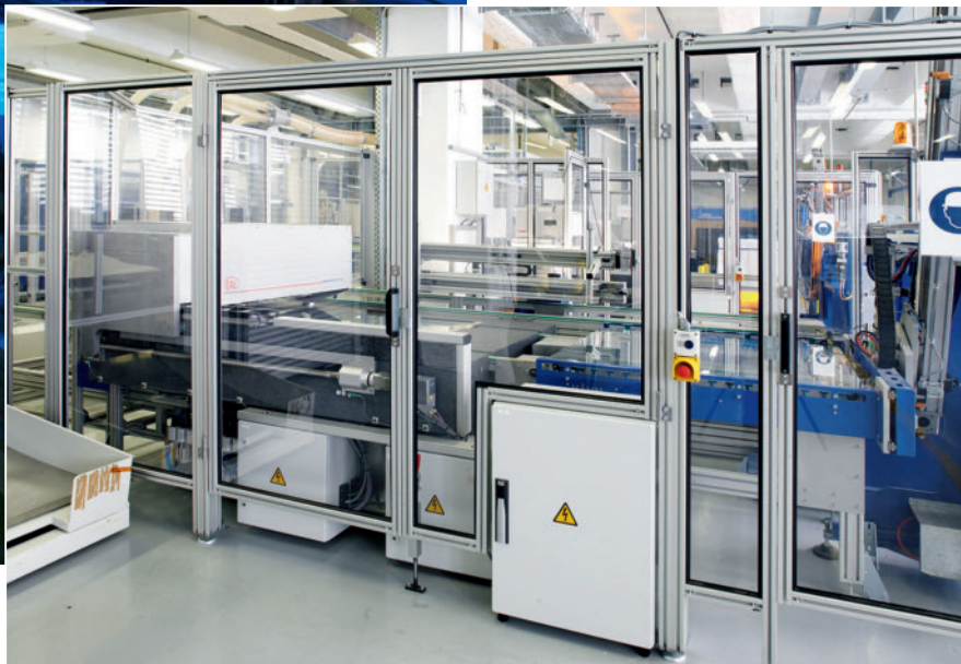
Bild 1. Prüfstation zur Wareneingangsprüfung von Flachgläsern für Dünnschicht-Solarstrommodule
