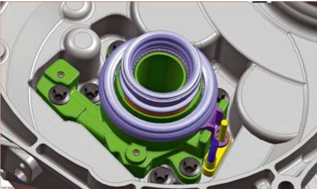
Doppeleinrücken verbaut im Getriebe: Der Sensor ermöglicht eine exakte Wegmessung bei reduziertem Bauraum
