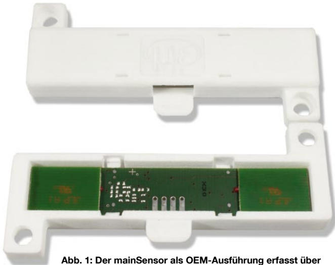
Abb. 1: Der mainSensor als OEM-Ausführung erfasst über einen Magneten den Abstand zum Messobjekt und so die Beladungserkennung.
