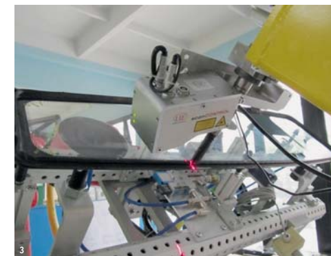
1 Der Sensor wird über viele Freiheitsgrade bewegt. Minimales Gewicht ist dabei wichtig. 2 Die Laserlinie wird nah an die Düse positioniert, um eine durchgängige Messung zu ermöglichen. 3 Alle Anschlüsse sind direkt im Gehäuse integriert.
