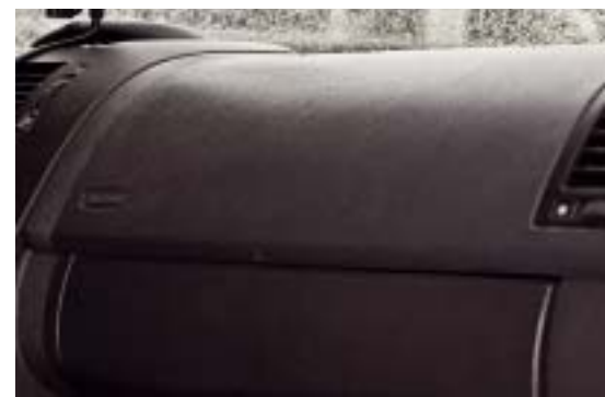
Dellen treten in der Instrumententafel an den Sollbruchstellen für Airbags auf. Sie verzerrten die Qualitätsanmutung des Fahrzeugs
