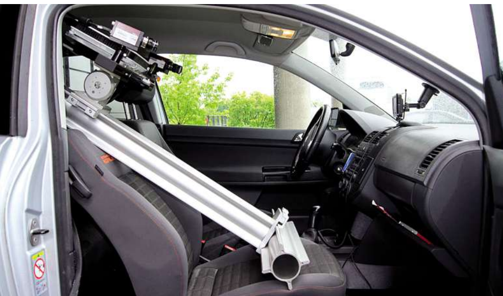
Das System SurfaceCONTROL auf einer mobilen Halterung montiert überprüft die Oberfläche der Instrumententafel.
