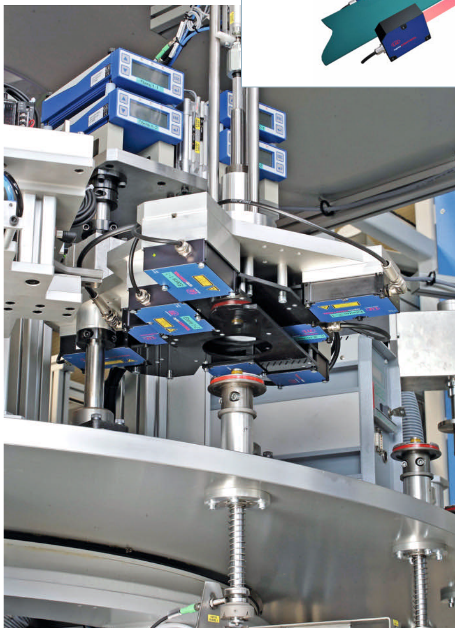
Bild 3. Durch das Baukastenprinzip lässt sich die Mechanik der Sensoren zur Spalt- und Kantenmessung an die Anwendung anpassen.
