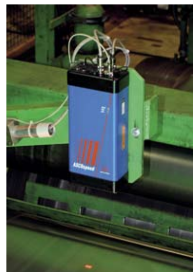
Abb. 7: ASCOSpeed misst die Bandgeschwindigkeit
