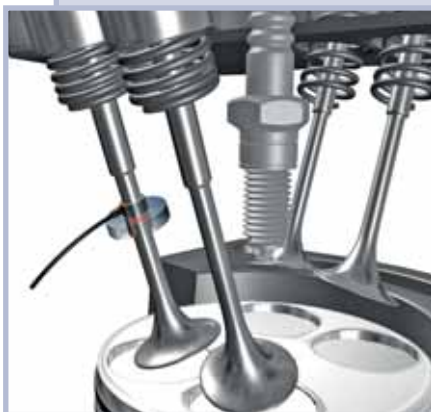
Der Ventilhubsensor befindet sich direkt am Schaft des Ventils und ermöglicht so eine effiziente Ventilsteuerung
