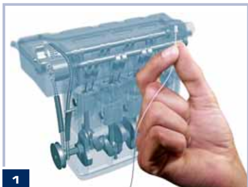
Bild 1. In etwa diese Größe besitzen Wirbelstromsensoren für den Einsatz in Motoren. Dank Keramikgehäuse überstehen sie auch den befeuchteten Betrieb
