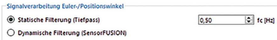
Im Bereich Signalverarbeitung Euler-/Positionswinkel kann wahlweise ein Tiefpassfilter (Frequenz 0,5 ... 25 Hz) oder eine dynamische Filterung des Ausgangssignals aktiviert werden.
