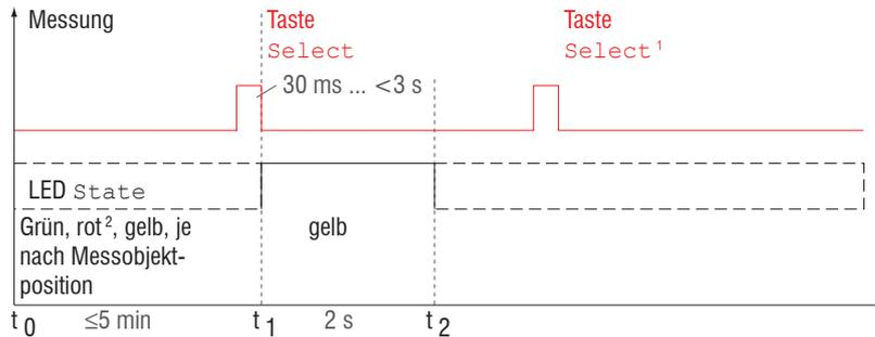
Abb. 30 Ablaufdiagramm für Nullsetzen, Mastern (Taste Select)
