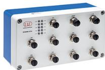
8-fach RS422 zu Ethernet Umsetzer mit industrial M12 Stecker/Buchse zum Anschluss von bis zu 8 Stück ILD1420, ILD1750, ILD1900, ILD2300 Sensoren oder IFC2451/61 Controller; zusätzlich 4 programmierbare Schaltein- und Schaltausgänge, die über TTL und HTL Logik angesprochen werden können; zulässiger Temperaturbereich Lagerung: +5 ... +50 °C; Schutzart IP65
