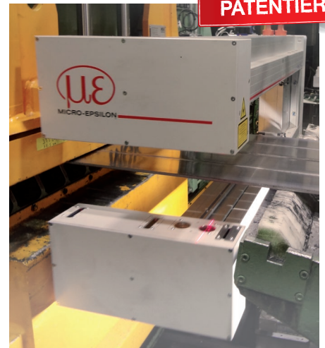
Zusätzliche Messung der Breite und der Säbeligkeit mit patentierter Kompensation toleranzinduzierter Effekte
