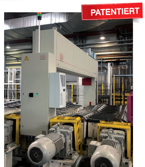
Patentierte Frame-in-Frame-Technologie mit integriertem Referenzrahmen zur Kompensation temperaturinduzierter Effekte
