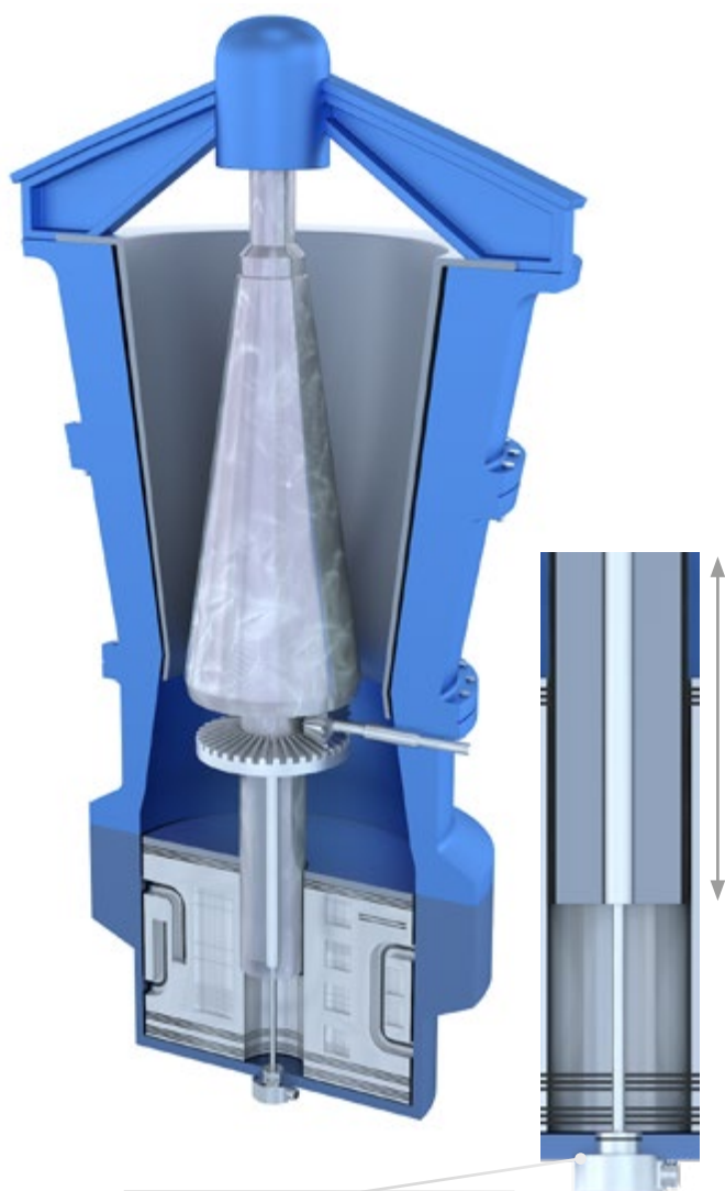
EDS-F: Messung des Mahlspalts in Gesteinsbrechern
