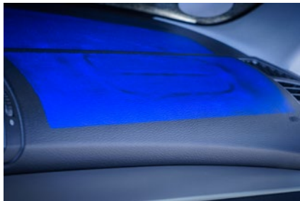
Vollflächige Rückprojektion des Inspektionsergebnisses
