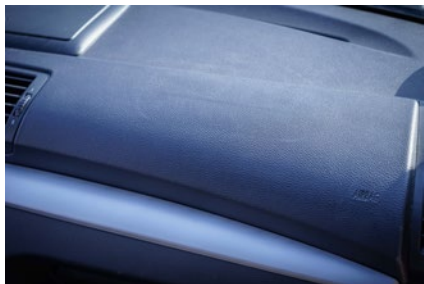
Bereich Beifahrerairbag Inspektion auf genarbtter Oberfläche
