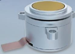
*Der Fast-Steering-Mirror wird in der laserbasierten Satellitenkommunikation eingesetzt. Das mikromechatronische System ermöglicht es, Laserstrahlen über einen Kippspiegel auf andere Satelliten zu lenken und richtungsstabil zu halten. Dadurch wird die Kommunikation zwischen weit entfernten Satelliten ermöglicht.*
