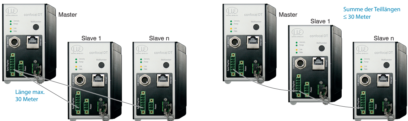
Abb. 18 Synchronisierung mehrerer Controller, links sternförmig, rechts verkettet
