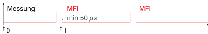
Abb. 63 Ablaufdiagramm für Nullsetzen, Mastern (Taste Multifunction)
