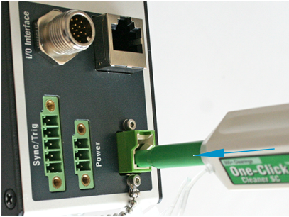
Abb. 83 One-Click™ Cleaner zum Reinigen von E2000-Lichtwellenleiterübergängen
