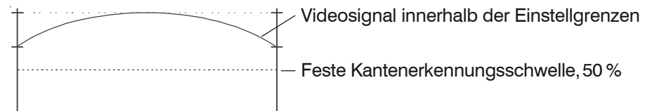
Abb. 8 Videobild mit fester Kantenerkennungsschwelle
