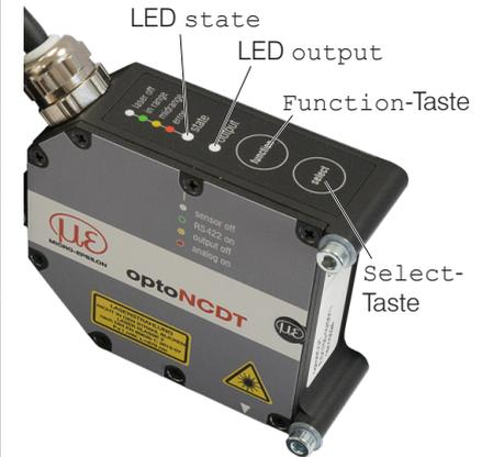
Die programmierbare Taste `Select` ruft die Funktionen `Master` oder `Teachen` auf. In den Werkseinstellungen sind die beiden Tasten 5 Minuten nach dem Einschalten der Spannungsversorgung aktiv. Danach werden sie automatisch gesperrt.
