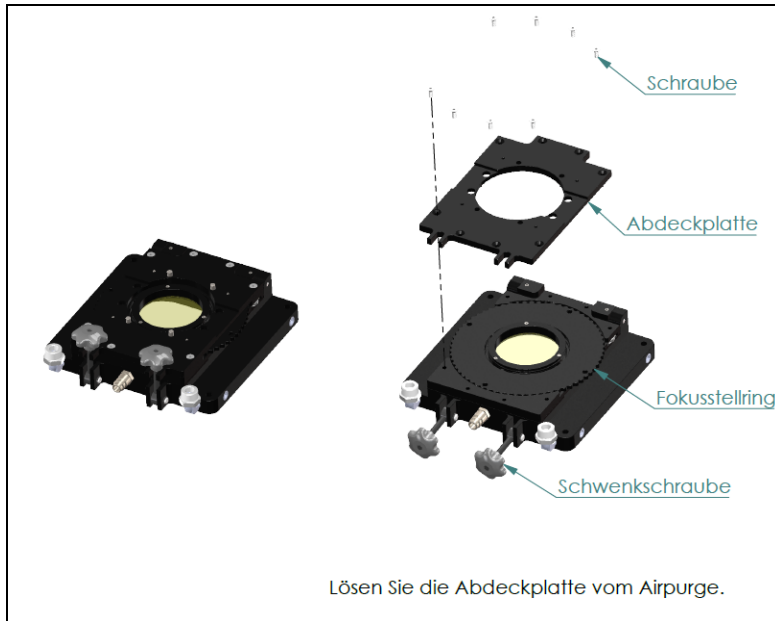
Abbildung 23: Montage des laminaren Freiblasvorsatzes
