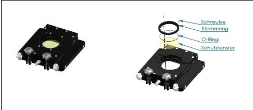
Abbildung 26: Wechsel des Schutzfensters
