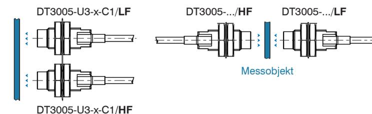
Beim Betrieb mehrerer eddyNCDT Messsysteme können diese mit einer neuartigen Frequenztrennung (LF/HF) geliefert werden. Die Frequenztrennung ermöglicht einen Mehrkanalbetrieb ohne gegenseitige Beeinflussung (Cross-Talk). Dank dieser Funktion ist eine Synchronisation über ein Synchronisationskabel nicht erforderlich.
