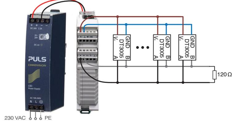
Anschluss der eddyNCDT 3005 Controller an das Schnittstellenmodul IF2035 mit optionalem Netzteil PS2020
