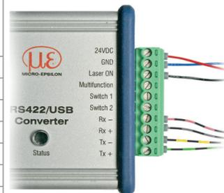
Symmetrische Differenzsignale nach EIA-422, nicht galvanisch von der Versorgungsspannung getrennt. Verwenden Sie ein geschirmtes Kabel mit verdrehten Adern, z. B. PC5500-3/OE-RJ45.
