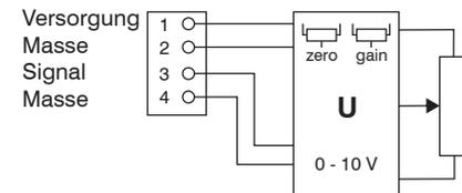
Ausführung mit Spannungsausgang
